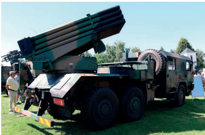
120 mm wyrzutnia raketowa WR-40 LANGUSTA, liczba luf – 40, czas wystrzelenia pełnej salwy 20 sekund.
